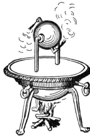
Figura 2.10 – Eolípila – motor a vapor de Hero de Alexandria Fonte: Løvland (2007)
