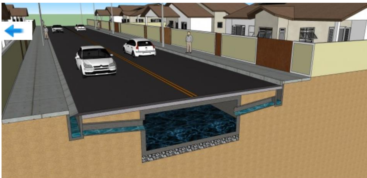
Mapa 3 Galeria de drenagem. Modificação no leito natural através da canalização. Fonte (Maricá.RJ, 2014)
