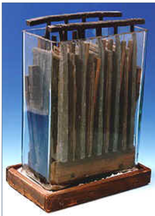
Figura 3 – Bateria de chumbo-ácido de Planté, 1859
