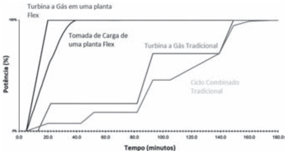
Gráfico 3: Comparação do Tempo Médio de Partida de Ciclos Flex da Siemens com Ciclos Combinados Convencionais
