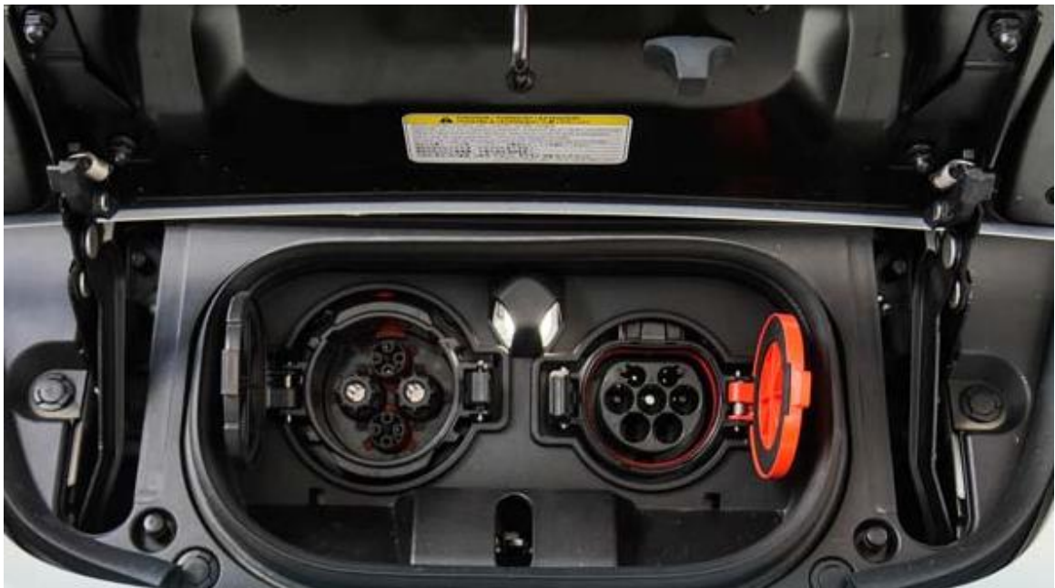
Figura 11. Conectores para recarga de um veículo elétrico (NISSAN LEAF 2018)
