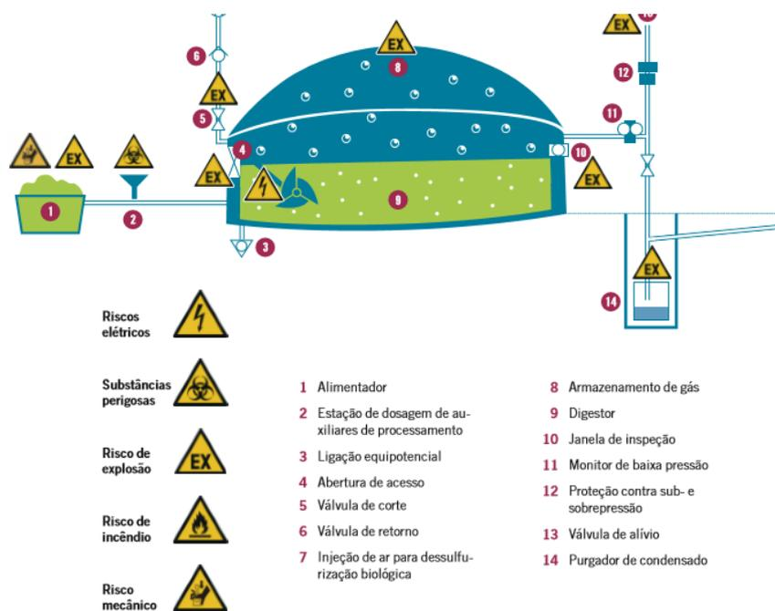
Figura 34: Visão geral de riscos em uma usina de biogás
