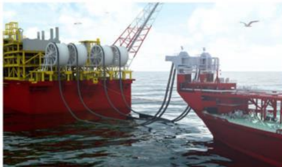
Figura 4 – Método de Descarregamento de GNL.
